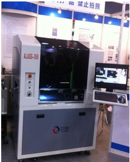
视觉全自动激光焊接设备
