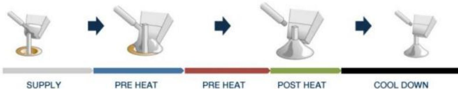
二 激光锡焊机的操作工序为：
